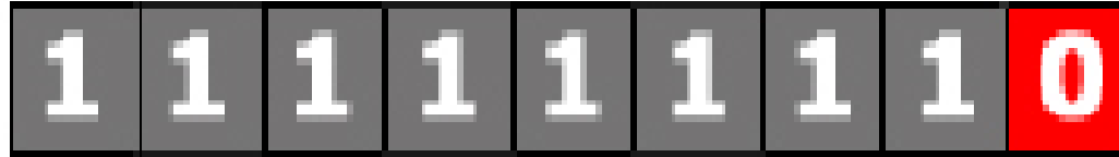
Obr. 11 Doplnění 9. bitu – indikace, že nejsou minimalizovány přechody
